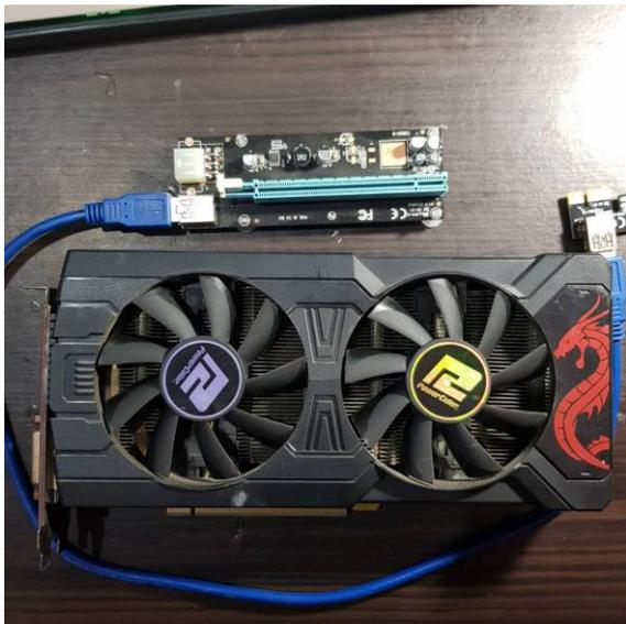
Gambar 3-2: GPU Powercolor RX 470 4GB dengan GPU Riser (Sumber: Dokumen Penulis).
